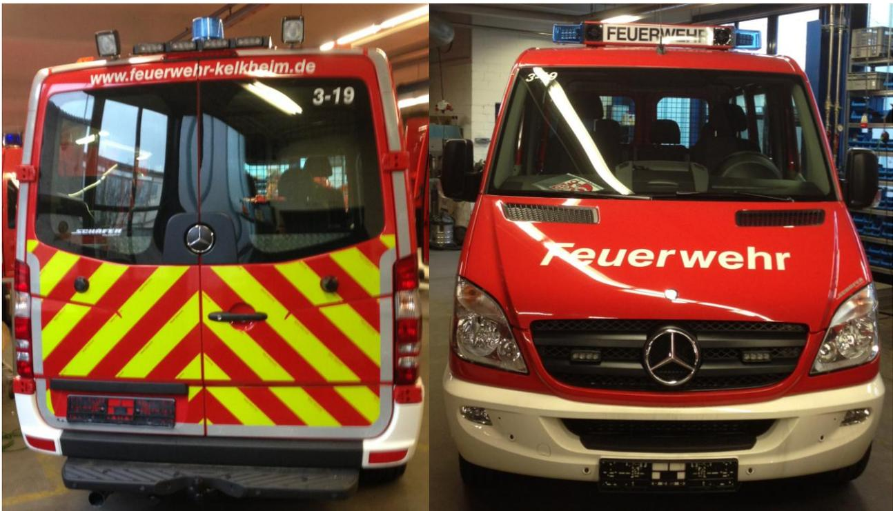
Besonders Auffällig ist das „französische Heck“, welches im Dunkeln reflektiert und eine zusätzliche Absicherung für die Einsatzkräfte darstellt. Besonders auf Kraftfahrstraßen wie der B8 ist dies von Vorteil.
